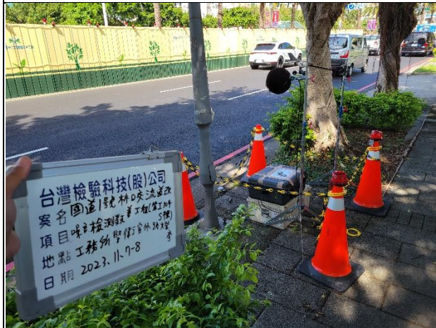
監測項目：環境噪音振動 監測日期：2023.11.07~08 監測地點：工務所警衛室外路燈旁
